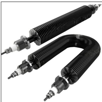
Трубчатые электронагреватели **ТЭНР** оребренные стальной лентой предназначены для нагрева воздушных сред: неподвижных (S) и движущихся со скоростью не менее 6 м/с (O).
