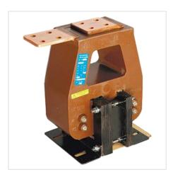
Трансформаторы ТЛК-СТ-10-ТВК предназначены для передачи сигнала измерительной информации измерительным приборам и устройствам защиты и управления, для изолирования цепей вторичных соединений от высокого напряжения в комплектных электрических устройствах внутренней установки (КРУ, КРУН, КСО) переменного тока на класс напряжения до 10 кВ.
