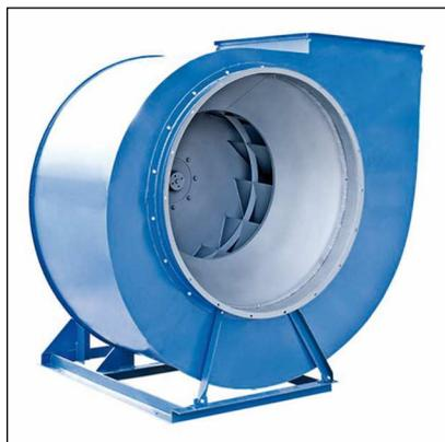
ВР-80-75-ДУ электровентилятор дымоудаления низкого давления обладает компактной конструкцией корпуса, лопатками, загнутыми назад и трехфазным асинхронным электродвигателем (380 В) с повышенным запасом надежности при высоких температурах. Вентилятор обладает классом защиты электродвигателя IP 54.
