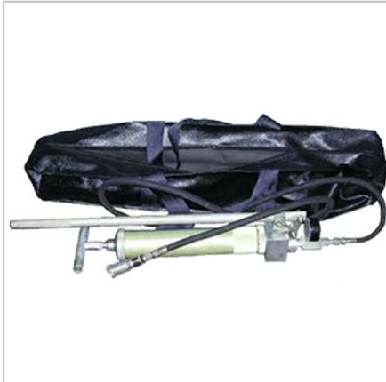
Нагнетатель высоковязких материалов ручной НВМр-500м предназначен для набивки под высоким давлением (до 50,0 МПа) высоковязких смазок и паст в уплотнительные узлы трубопроводной арматуры, а также для набивки очистителя каналов.
