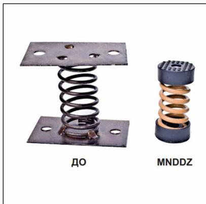
Виброизолятор используется с целью предотвращения распространения по строительным конструкциям вибрации от вентиляторов. Виброизолятор устанавливается в соответствии с указаниями в паспорте вентилятора.
