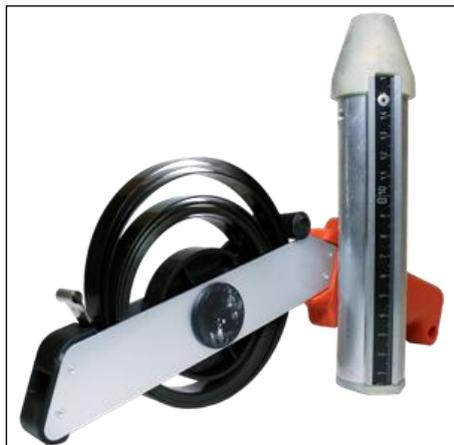
Измерительные рулетки с грузом 2 и 3 классов точности предназначены для измерения уровня нефти и нефтепродуктов в транспортных и стационарных емкостях.
