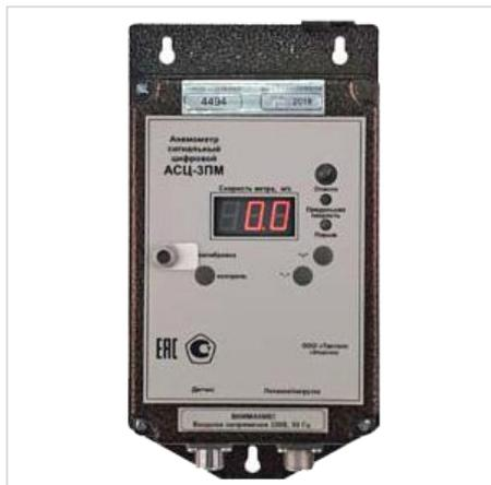
Анемометры сигнальные цифровые АСЦ-ЗПП и АСЦ-ЗПМ предназначены для измерения скорости воздушного потока (ветра) и сигнализации при достижении предельно-допустимых значений.
