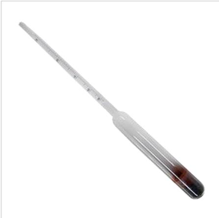
Ареометры для этиленгликоля АЭГ (20-100) используется для определения концентрации этиленгликоля в жидкости, а также определения плотности тосолов и антифризов.
