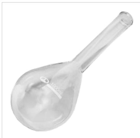
Колбы Къельдаля предназначены для использования в аппарате Къельдаля, применяемого для определения азота.
