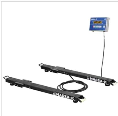
Платформенные весы серии 4D-B-12/1-AB предназначены для статического взвешивания грузов при учетных и технологических операциях на промышленных и торговых предприятиях. 4D-B-12/1-AB состоят из весового терминала АВ и грузоприемной платформы стержневого типа 4D-B-12/1. Материал весового модуля - сталь общего назначения с покрытием порошковой краской, корпус терминала – нержавеющая сталь.
