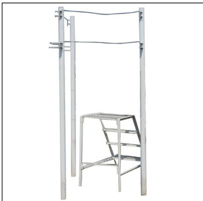
Гололедный станок позволяет измерить отложения льда (гололед), мокрого снега, изморози на проводах.
