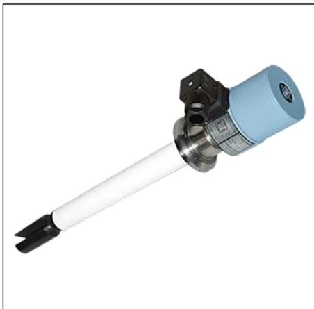
Сигнализаторы уровня жидких материалов серии СКАТ используются для контроля уровня жидкостей с вязкостью от 0,3 до 10000 мПа·с плотностью от 0,5 до 2,5 г/см<sup>3</sup>, например, для воды, кислот, щелочей, растворителей, масел, смол, разнообразных растворов, эмульсий и других жидких материалов.
