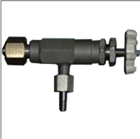
Вентиль ВТР-1 предназначен для точной регулировки расхода для сред с давлением до 150 кгс/см<sup>2</sup>. Устанавливается на баллоны любого литража, для 40-литровых баллонов вентиль комплектуется переходником.
