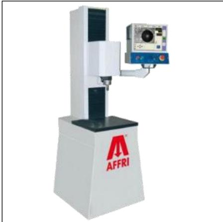
Твердомер предназначен для измерения твердости любых материалов по Роквелл согласно стандартам: ISO 6508; по Бринелль согласно стандартам ISO 6506-2; по Виккерс согласно стандартам ISO 6507-2, ASTM E 18, ASTM E10; по Шор согласно стандартам ASTM 2240.
