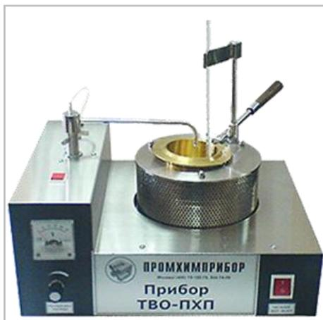
Аппарат предназначен для определения температуры вспышки нефтепродуктов, нагреваемых с установленной скоростью в открытом тигле, в момент вспышки паров нефтепродукта над его поверхностью.
