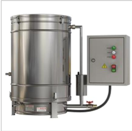
Электрический аквадистиллятор АДЭ-50 предназначен для производства дистиллированной воды из исходной путем её нагрева до кипения с дальнейшей конденсацией водяного пара и получением дистиллята с температурой в пределах от +70°С до +85°С.
