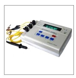
Мегаомметры применяются для измерения сопротивления электрической проводов, кабелей, трансформаторов, обмоток электрических машин и других устройств, а также для измерения поверхностных и объёмных сопротивлений изоляционных материалов.
