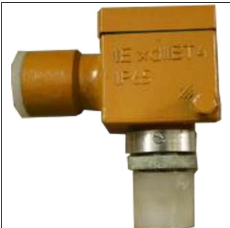
Датчики магнитоиндукционные 1НОРД-И1У и 1НОРД-И2У (далее «датчики») предназначены для преобразования скорости вращения турбинки турбинного преобразователя расхода в частоту электрического сигнала в датчике 1НОРД-И1У, усиления этого сигнала в датчике 1НОРД-И2У.
