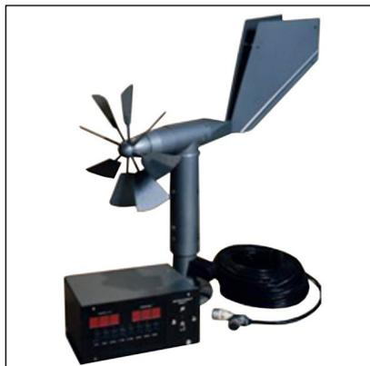
Анеморумбометр **М63-М1** предназначен для дистанционного измерения мгновенной, максимальной и средней скоростей и направления ветра в стационарных условиях.
