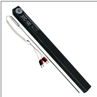
Эталонный термометр сопротивления **ЭТС-100** предназначен для проверки рабочих средств измерения температуры в диапазонах температур от -196 до 0 °С или от 0 до +660 °С в соответствии с ГОСТ 8.558-93.
