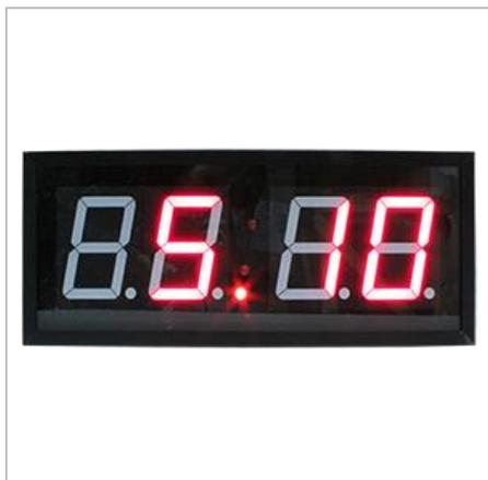
Первичные часы ЧС-100б-школа, с функцией управления звонками, предназначены для обеспечения единых показаний времени на всех часах, подключенных к системе.
