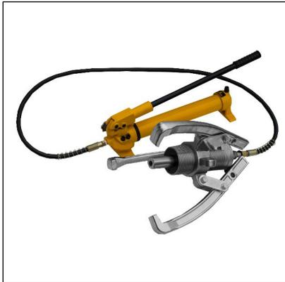
Гидравлический съёмник **СГ-30Н** с выносным (внешним) насосом предназначен для демонтажа подшипников, зубчатых колес, шкивов, ступиц и иных, установленных с натягом, деталей с валов.
