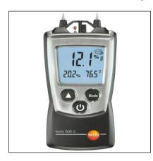
Влагомер **testo 606-2** предназначен для измерения влажности древесины и стройматериалов, имеет встроенный сенсор влажности и NTC термометр воздуха, защитную крышку, батарейки и заводской протокол калибровки. Номер заказа 0560 6062
