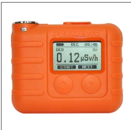
Предназначен для измерения индивидуального эквивалента дозы и мощности индивидуального эквивалента дозы непрерывного и импульсного рентгеновского и гамма излучений.
