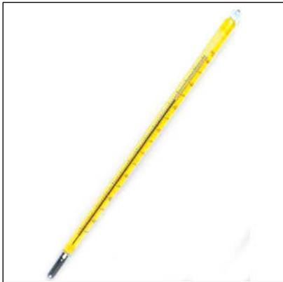
Термометр стеклянный ртутный палочковый «ТМ-8» предназначен для быстрого замера температуры воздуха в походной обстановке путем вращения термометра на шнурке со скоростью порядка 1 об/сек.
