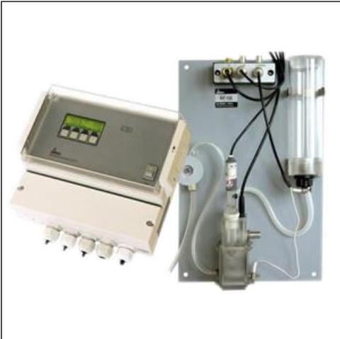
Комплекс измерительный рН-220.7 предназначен для определения активности ионов водорода рН в системах водоподготовки ТЭЦ и АЭС. Предусмотрена возможность автоматического приведения значения рН, измеренного при температуре анализируемой среды от 0 до 50°С. к 25 °С. Комплект состоит из выносного входного усилителя, блока преобразования, гидравлического блока.
