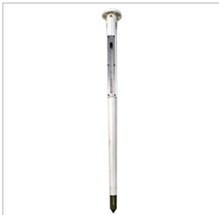
Термометр-щуп АМ-6 предназначен для измерения температуры в пахотном слое почвы. Термометр АМ-6 состоит из жидкостного толуолового термометра ТС-6Тл, размещенного в оправе, ручки, металлического конусообразного наконечника и мелких, сухих, обезжиренных медных или латунных опилок.
