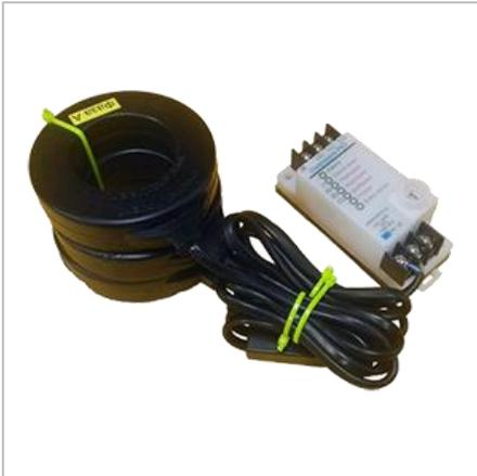
Предназначено для установки в цепях питания трёхфазных электроустановок (электродвигателей, трансформаторов и других ответственных агрегатов) с целью повышения их надежности и увеличения срока службы. Смартреле-РК3 осуществляет контроль токов в трех фазах обслуживаемой электроустановки и при выявлении аварийных режимов работы отключает ее.
