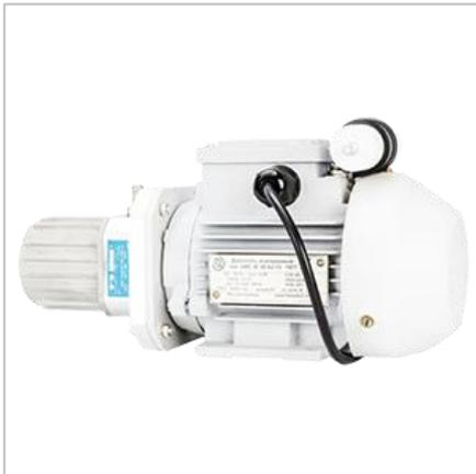
Пластинчато-роторный насос 2НВР-0,1ДМ применяется для откачки из герметичных емкостей объемов воздуха паров, газов и парогазовых смесей, заранее очищенных от механических загрязнений, капельной влаги, атмосферного давления до предельного остаточного.
