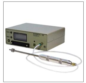
Предназначен для измерения содержания вредных веществ в воздухе рабочей зоны.
