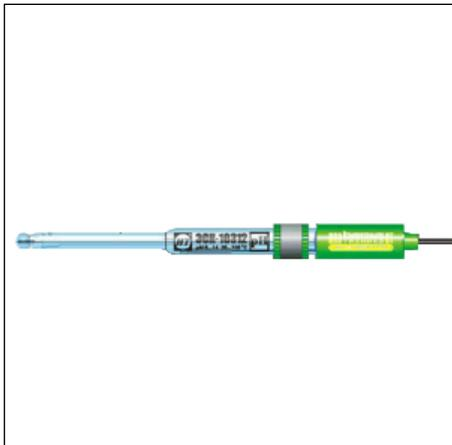
Лабораторный комбинированный "полумикро"-электрод для измерения рН используется для анализа растворов в емкостях с узким горлом (пробирки, колбы, бутылки и т.д.), а также проб малых объемов (~ 0,2 - 0,5 мл). Предпочтителен для измерений при повышенной температуре, а также анализа сильнощелочных растворов с высоким содержанием ионов Na<sup>+</sup>.
