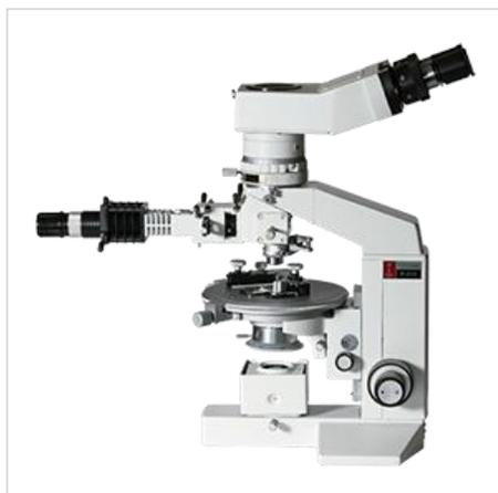
Микроскоп предназначен для исследований непрозрачных объектов в отраженном свете, обыкновенном и поляризованном, а также прозрачных объектов в проходящем свете при малых увеличениях.
