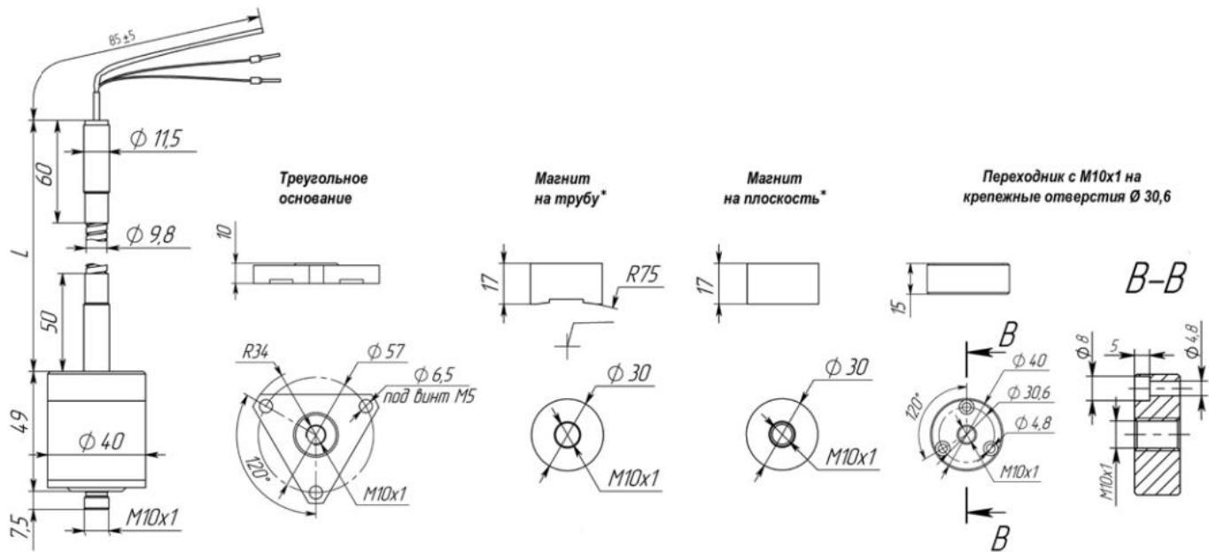
\*Продолжительная эксплуатация магнита допускается при температуре  $t \leq 80^\circ\text{C}$ .
