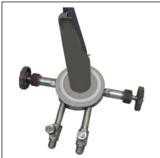
Зонд пробоотборный предназначен для отбора проб товарной нефти, транспортируемой по трубопроводам с условным диаметром от 40 до 1200 мм и давлением от 0,2 до 6,3 МПа.
