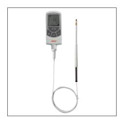
Предназначен для измерения относительной концентрации соли в пищевых продуктах: мясо, нарезки, ветчина, сыры, салаты.
