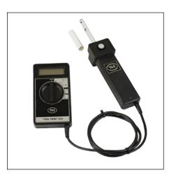
Предназначен для измерения освещённости в видимой области спектра (380 ÷ 760) нм, температуры и относительной влажности воздуха внутри помещений.
