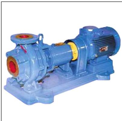
Центробежный насосный агрегат **К-20/30** предназначен для перекачивания в стационарных условиях воды (кроме морской) и иных жидкостей, имеющих активную кислотность в пределах от 6 до 9 (рН) и одинаковые с водой физико-химические свойства. Объемная концентрация твердых включений в перекачиваемой жидкости не должна превышать 0,1%, размер частиц – не более 0,2 мм.
