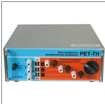
Блок **РЕТ-ТН** предназначен для масштабирования трехфазной системы напряжений на выходе приборов РЕТОМ-51 и РЕТОМ-61 с коэффициентами трансформации  $1/\sqrt{3}$ , 1,  $\sqrt{3}$ , 5.
