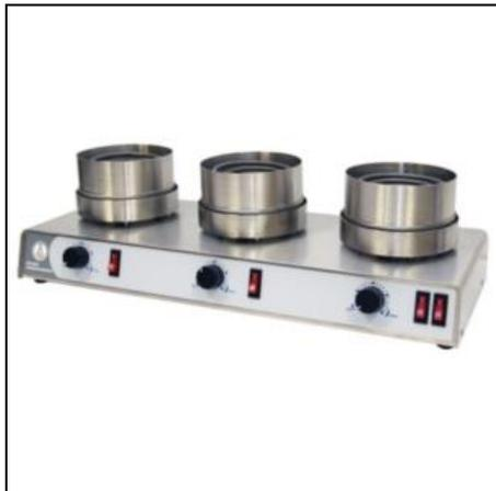
Колбонагреватели **LOIP LH-200** применяются для нагрева жидкостей и твердых веществ, проведения синтеза и перегонки, контроля фракционного состава, определения содержания воды по действующим стандартам и других задач, предусматривающих нагревание при температурах до +600°C. Трехместная модель **LOIP LH-253** предназначена для нагрева колб объемом от 250 до 1000 мл.
