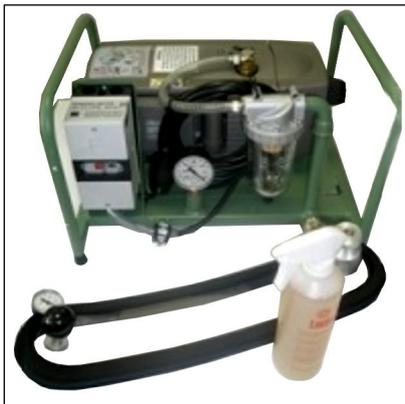
Вакуумный течеискатель **KOWOVAC-VSP-3T** предназначен для контроля герметичности сварных швов в резервуарах, трубопроводах и иных сварных конструкциях с помощью пенообразующего раствора. Течеискатели можно применять также для контроля литейных изделий на наличие сквозных дефектов (трещин, пористости).
