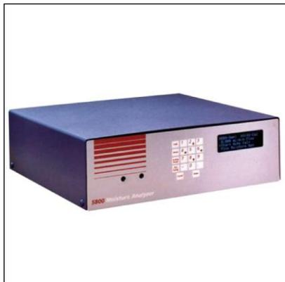
Анализаторы влажности газов **5800, 5830** предназначены для определения влажности в различных газах, в том числе сверхчистых, защитных, углеводородных и водородосодержащих, преимущественно, в лабораторных условиях. Они используют пьезокристаллический принцип, основанный на анализе изменения частоты колебаний кварцевого кристалла.
