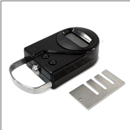
Электронный адгезиметр серии АМЦ-2 предназначен для измерения и контроля адгезионной прочности покрытия на различных конструкциях. Адгезиметр определяет минимальное, максимальное и среднеинтегральное значение усилия отслаивания (отрыва) за определенный промежуток времени, а также имеет звуковую сигнализацию событий.
