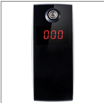
Алкотестер **Динго А-055** является персональным анализатором паров алкоголя в выдыхаемом воздухе. Измеренное значение концентрации паров алкоголя в легких пересчитывается в концентрацию алкоголя в крови и отображается на дисплее. Питание осуществляется с помощью двух щелочных (алкалиновых) батареек АА.
