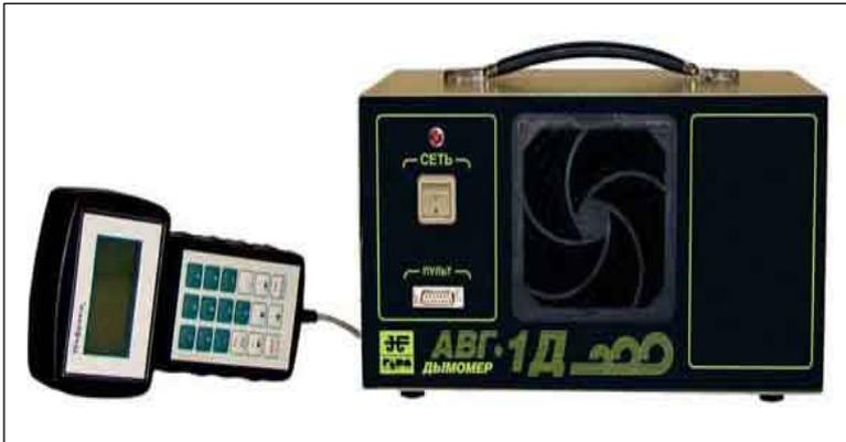
Дымомеры АВГ-1Д предназначены для измерения дымности отработавших газов дизельных двигателей автомобилей, а также для измерения частоты вращения коленчатого вала автомобилей. Прибор полностью соответствует требованиям ГОСТ 21393-75 и ГОСТ 52160-2003.
