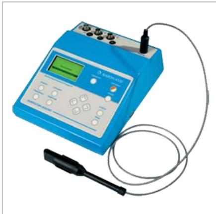
Лабораторный 3-х каналный иономер/кондуктометр 3 канала (мВ/pH (рХ), М, С) + УЭП/Csal + °С. Самая популярная модель среди комбинированных анализаторов. Соединяет в себе достоинства 3-х каналного иономера АНИОН 4110 и кондуктометра АНИОН 4120 в одном корпусе.
