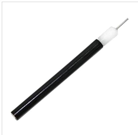
Хлорсеребряный электрод (ХСЭ) представляет собой спираль из серебряной проволоки, покрытой хлоридом серебра и помещенной в полипропиленовый корпус с полупроницаемой пробкой из оксида алюминия. Перед применением корпус электрода заполняют раствором хлорида калия концентрации 1 моль/л. Хлорсеребряный электрод используют в соответствии с применяемой методикой измерений в качестве электрода сравнения, вспомогательного электрода или применяют при модифицировании поверхности рабочего электрода.
