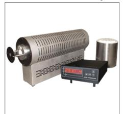
Абсолютно черное тело АЧТ-45/100/1100 являются эталонными излучателями (не ниже II разряда) и предназначено для градуировки и поверки пирометров в диапазоне температур 300...1100°С в лабораторных и цеховых условиях.
