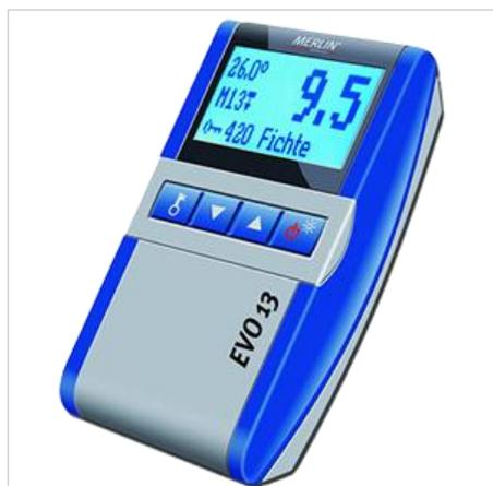
Влагомеры серии EVO предназначен для измерения влажности древесины, мебели и напольных покрытий.
