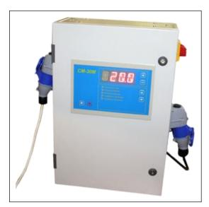
Предназначен для создания в контролируемом изделии постоянного магнитного поля с помощью соленоида, а также размагничивания изделия убывающим магнитным полем меняющейся полярности. Дефектоскоп рассчитан на работу с соленоидом Э600 с внутренним диаметром 600мм и позволяет создать в его центре поле напряженностью 350 А/см.
