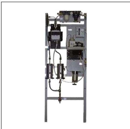
Предназначен для подготовки пробы газа, содержащей большое количество газообразной влаги без потери анализируемых компонентов. В комплекте с зондом и обогреваемой импульсной линией обеспечивает подготовку газа на высокозапыленных средах.
